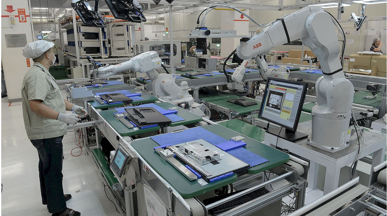
Roboter bei der Montage in der Elektronikindustrie © ABB
