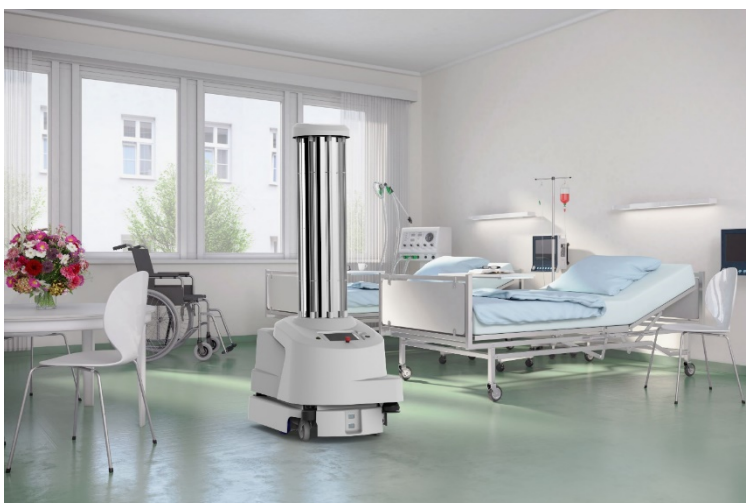
„UVD Robot“ von Blue Ocean Robotics fährt autonom und beseitigt Bakterien und andere schädliche Mikroorganismen in Krankenhäusern. © Blue Ocean Robotics
